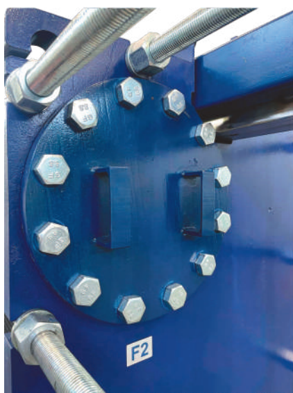
Фланец на задней плите для очистки фильтра
